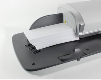
Stellen Sie sicher, dass alle Kuverts (beginnend mit den grössten bis hin zu den kleinsten Kuverts) entlang der hinteren Führungsleiste aufgestapelt sind.
