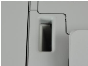
2. Ziehen Sie den unter der Basis befindlichen Auslösegriff, um die Transportbänder und -räder abzusenken. Halten Sie den Griff fest.
