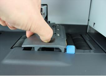
4. Heben Sie den Schwammhalter aus Metall an, um den Schwamm zu entfernen. Merken Sie sich dessen Ausrichtung.
