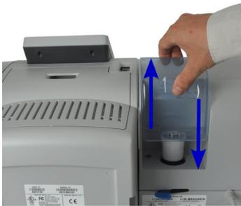
2. Drehen Sie den Deckel ab, und füllen Sie den Behälter bis zur Grenzmarkierung mit Wasser.
