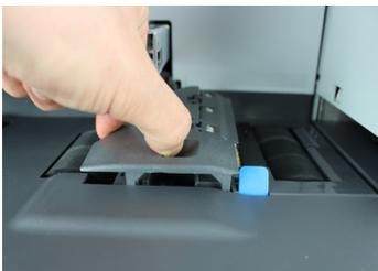
4. Entfernen Sie eingeklemmte Kuverts.
