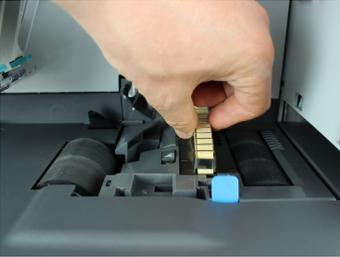
5. Reinigen Sie den Schwamm und die Bürste.
