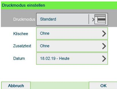
Zum Ändern des Druckmodus wählen Sie Druckmodus und anschliessend [Standard] im Bildschirm Druckmodus aus. Weitere Informationen finden Sie unter [Vorgehensweise beim Ändern des aktuellen "Druckmodus"](#) auf Seite 41.
