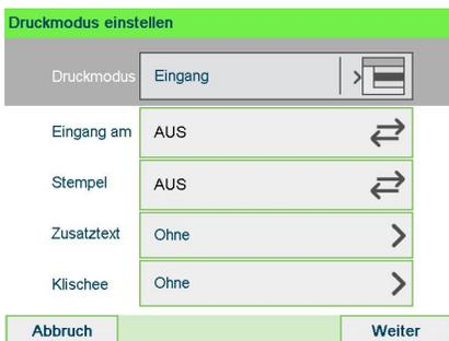
Zum **Ändern des Druckmodus** wählen Sie Druckmodus und anschliessend **[Eingang]** auf dem Bildschirm Druckmodus aus. Weitere Informationen finden Sie unter [Vorgehensweise beim Ändern des aktuellen Druckmodus](#) auf Seite 41.
